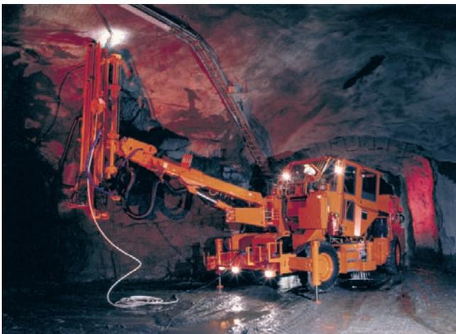
Equipo moderno para la instalación de bulones de sostenimiento.
