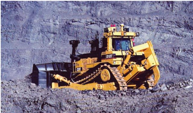
Tractor de orugas o *bulldozer*, con sus dos herramientas de trabajo: escarificador o *ripper* en la parte posterior y la hoja de empuje en la parte delantera.
