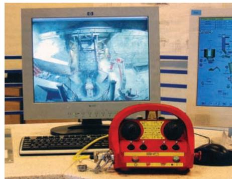
Sala de control de una planta de concentración con imagen en el monitor de la trituradora primaria.
