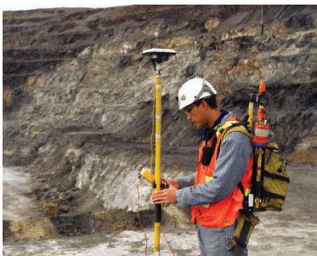
Utilización del sistema GPS para el levantamiento topográfico de la mina.
