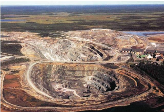
Mina metálica a cielo abierto en primer plano y escombreras de estériles rocosos.
