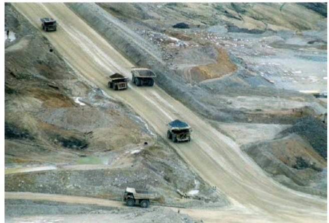
En la actualidad, el enorme coste de la maquinaria de movimiento de tierras obliga a un elevado grado de utilización y a la eliminación de los tiempos de espera. En la gran minería, esto se consigue mediante el control de movimientos utilizando el GPS y los sistemas informáticos.
