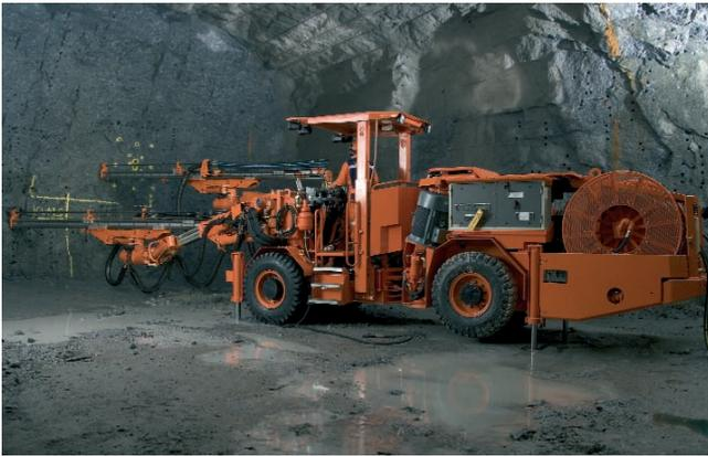
Equipo de perforación jumbo en una mina subterránea.
