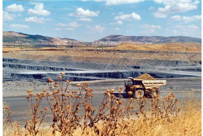
Transporte de roca estéril de una mina de carbón a cielo abierto. Mina Emma de Puertollano, Ciudad Real.
