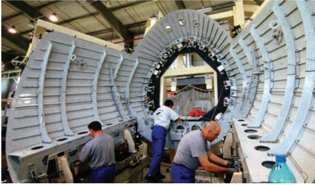
Montaje del fuselaje de un avión.
