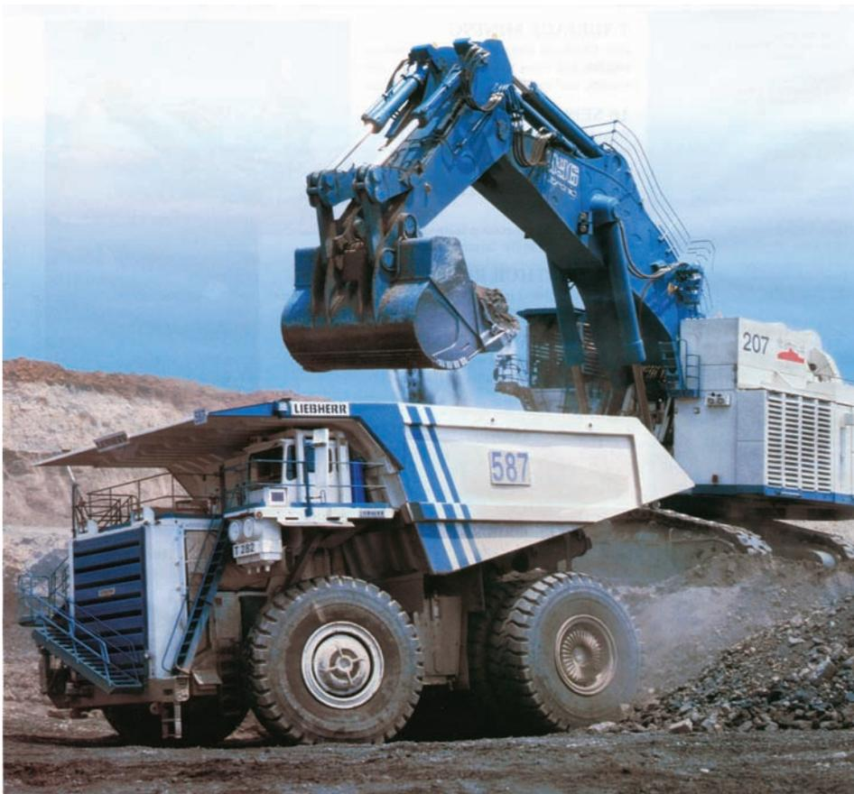
Volquete de 400 t de capacidad cargado con una excavadora hidráulica en una mina de carbón.
