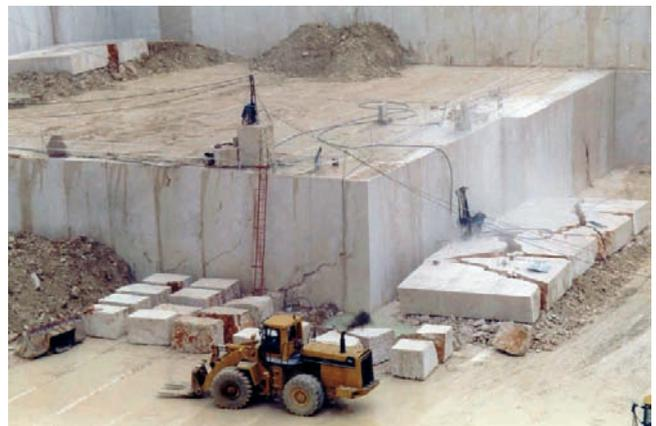
Cantera de roca ornamental, en Cehegín, Murcia. Se aprecia el corte y la carga de los bloques de mármol, con destino al taller de serrado y pulido.
