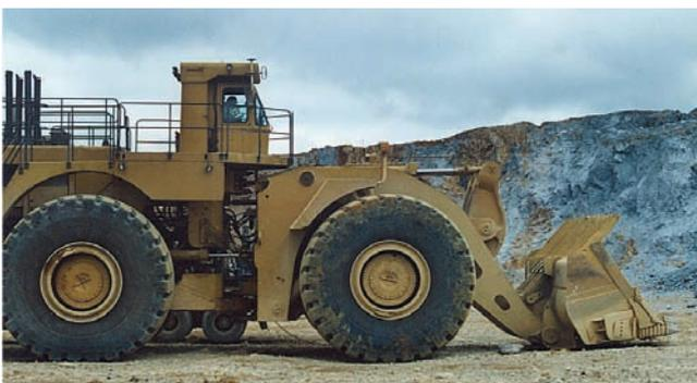
Pala cargadora con una cuchara capaz de levantar 35 t.
